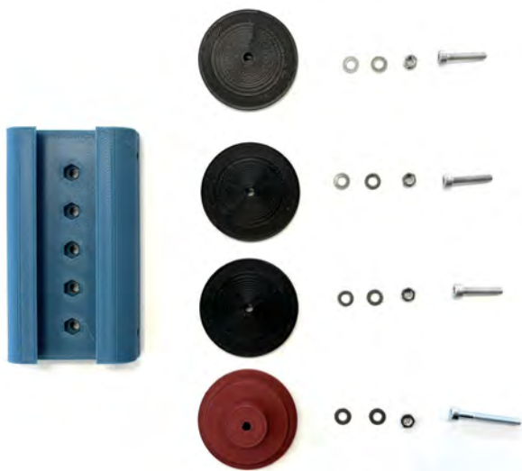
Abb. 3: Die benötigten Komponenten sind: 8x M3 Unterlegscheiben, 4x M3 Muttern, 1x M3x25 Schraube (für das Antriebsrad) und 3x M3x16 Schrauben. Prüft, ob die Schrauben die passende Länge haben. Wie man die passende Länge bestimmt, steht in den Hinweisen im Abschnitt Einleitung.
