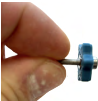
Abb. 14: Die Halteschraube macht die spätere Justage des Motorhalters einfacher.
