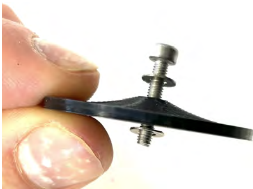
Abb. 4: Vor und hinter die Räder werden jeweils Unterlegscheiben gesteckt.
