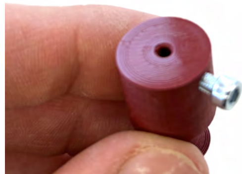
Abb. 10: Eine M3x8 Schraube wird ca. zur Hälfte in den Motoraufsatz geschraubt.
