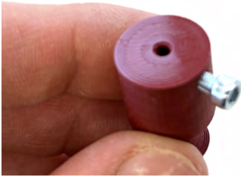
Abb. 10: Die M3x8 Schraube wird ca. zur Hälfte in den Motoraufsatz geschraubt.
