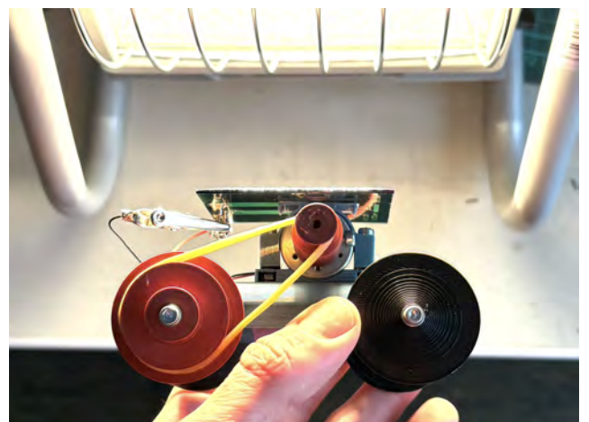
Abb. 22: Testen der Spannung des Gummibandes vor einer starken Lichtquelle.
