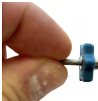
Abb. 14: Die Halteschraube macht die spätere Justage des Motorhalters einfacher.
