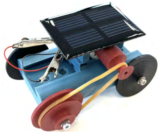
Abb. 18: So sieht das fertig montierte Solarauto aus.
