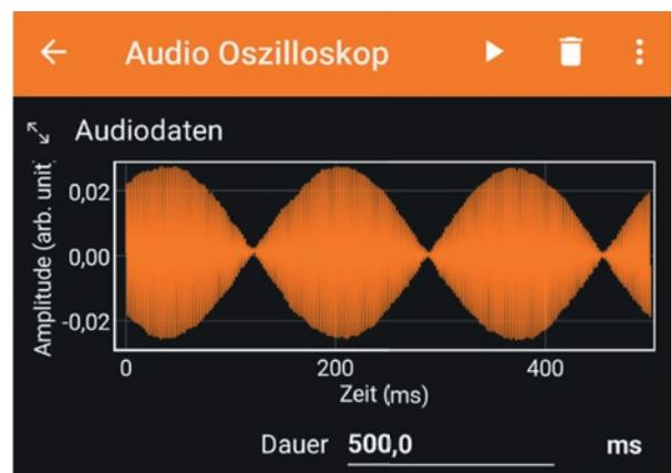
Abb. 14. Visualisierung der Schwabung zweier Töne mit 440 Hz und 446 Hz durch ein drittes Smartphone
