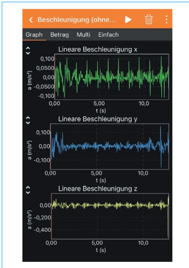
Abb. 4. Typische Messergebnisse des Beschleunigungssensors von einem auf der Brust liegenden Smartphone
