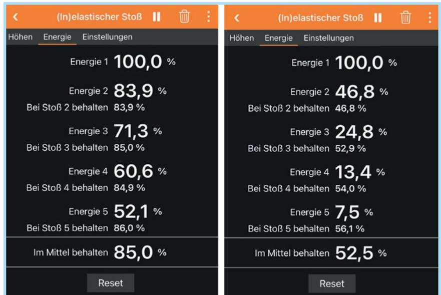
Abb. 3. Tischtennisball (links) und Plastikball (rechts) im Vergleich beim Aufprall auf eine Tischplatte aus Holz
