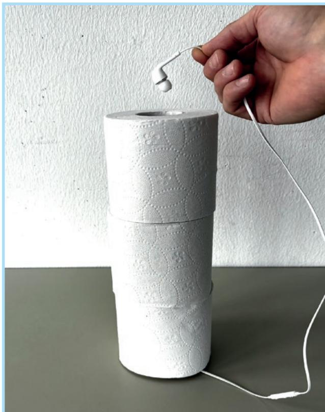
Abb. 18. Experiment zur Interferenz von Schallwellen, hier mit Toilettenpapier als Röhre
