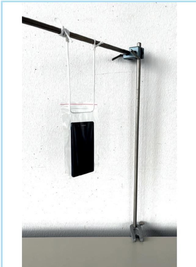
Abb. 8. Einfacher bifiler Aufbau eines Fadenpendels mit einem Druckverschlussbeutel
