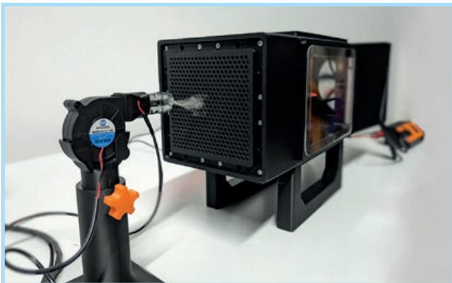
Abb. 7. Die Raucheinheit ist vor dem Gleichrichter platziert
