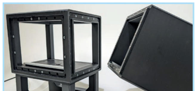
Abb. 6. Die Module (hier: Testkammer und Diffusor) werden mithilfe eines magnetischen Stecksystems verbunden
