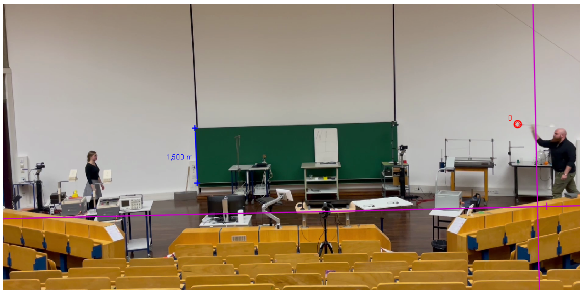
Abbildung 7.4: Aufbau des Experimentes mit der in Tracker festgesetzten Achse und dem Maßstab. Der Maßstab in blau ist der linke Rand der Tafel. Die Achsen in pink.
