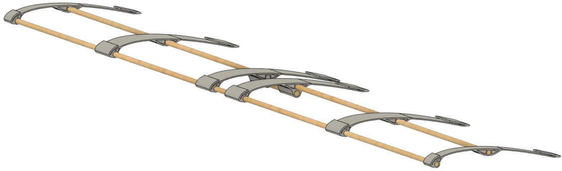
Abbildung 5.6: Darstellung des Tragflächengerippes des konstruierten Modellflugzeugs. Die einzelnen Tragflächenrippen werden über Holzstäbe verbunden.
