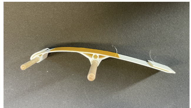
Abb. 28: Schritt 1 bei dem zusammensetzen des Tragflächengerippes.
