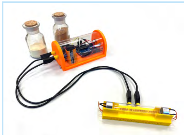
Abb. 7. Handliche low-cost-Version des KUNDT'schen Rohrs: Betriebsgerät (orange) und Halterung für Plexiglasröhre und Ultraschallsender (gelb)
