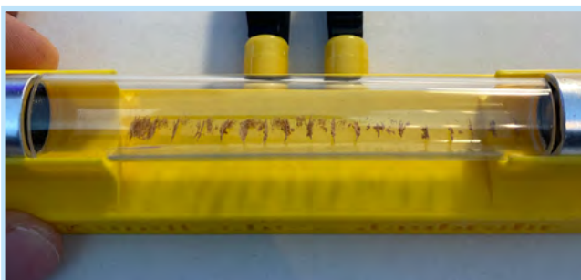
Abb. 9. Typisches Muster im KUNDT'schen Rohr
