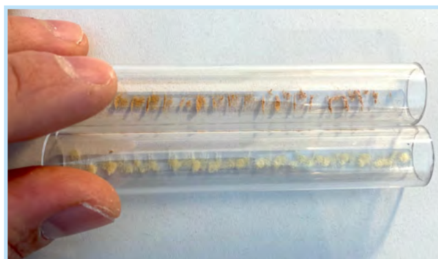
Abb. 10. Durch das Entfernen der Röhre können die Abstände einfacher bestimmt werden. Oben: feines Korkmehl; Unten: Lycopodiumpulver
