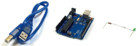
Abbildung 1: Benötigt wird ein USB-Kabel, der Arduino UNO und eine LED samt angelegtem 220 \Omega Vorwiderstand sowie ein Computer samt Arduino-Software (z.B. der kostenlosen Arduino-IDE von https://www.arduino.cc/en/software )
