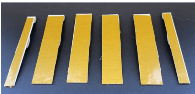
Abb. 36: Die planen Tragflächenrippen werden mit doppelseitigem Klebeband beklebt.
