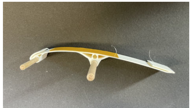
Abb. 28: Schritt 1 bei dem zusammensetzen des Tragflächengerippes.
