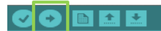
Abbildung 5: Bedienleiste in der Arduino-Software von arduino.cc. Mit einem Klick auf den Pfeil wird der Sketch auf den Arduino hochgeladen.
