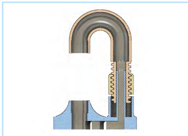
Abb. 2. Schnittbild durch die dreiteilige Halterung
