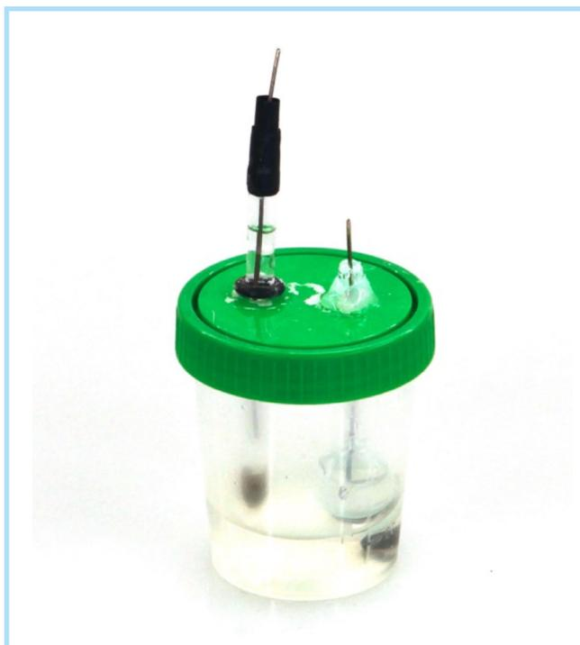
Abb. 4. Nach den Vorgaben von ROCHA ET AL. (1995) gefertigte Referenzelektrode (links) pH-Elektrode (rechts).
