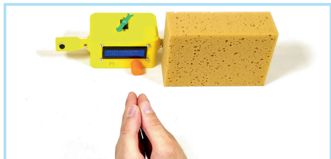
Abb. 6. Sind Hindernisse im Schallweg, kann die Schaltung die Richtung nicht mehr genau bestimmen
