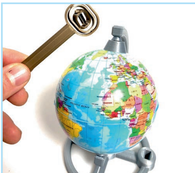
Abb. 3. Experiment zur Untersuchung der Richtung des Verlaufs der Feldlinien des Erdmagnetfeldes mit einer Sonde
